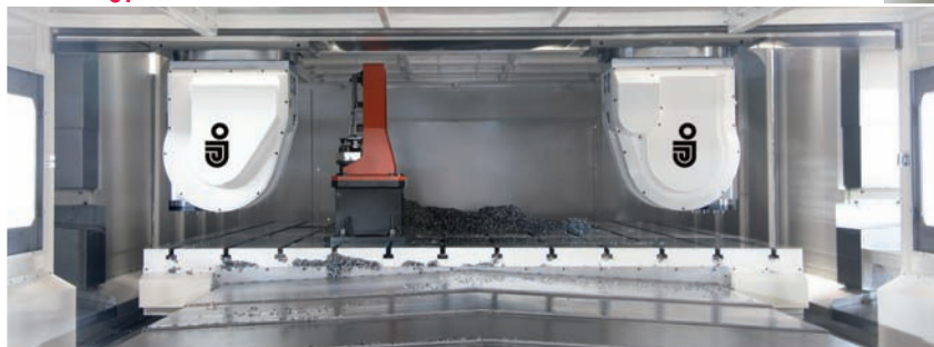
Due aspetti della Tarkus DS considerata da Jobs altamente innovativa sia per la struttura sia per la doppia testa per la lavorazione del titanio.
