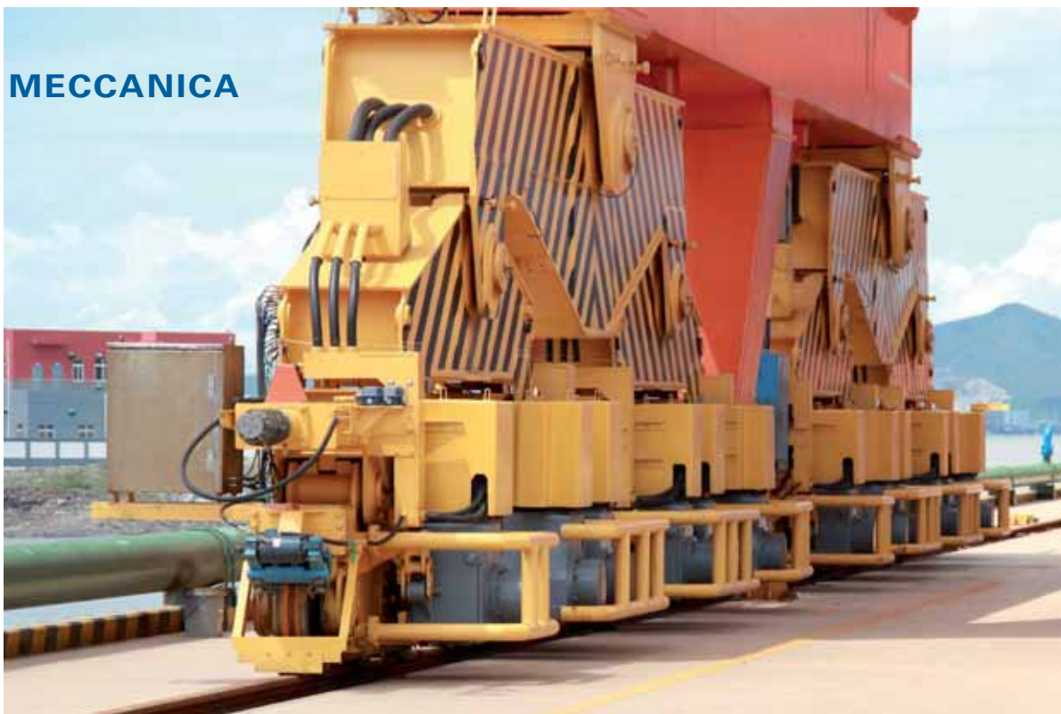
Tutti i riduttori sono prodotti da un singolo blocco carcassa.
