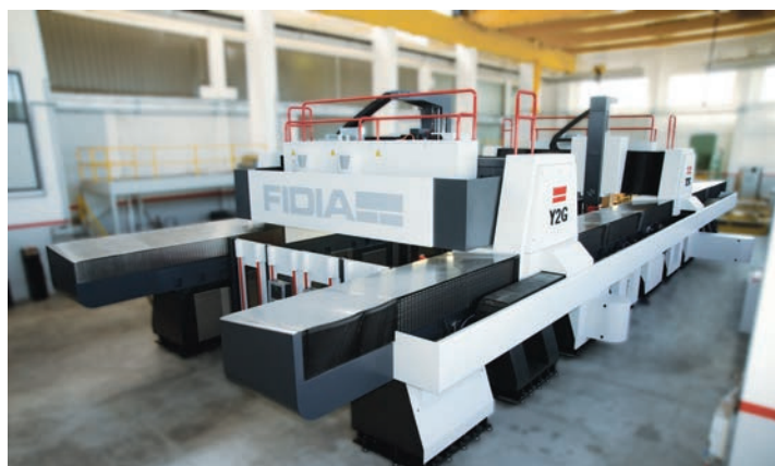
Gantry GTF/35 adatta per lavorazioni rapide di materiali compositi. Macchina della famiglia GTF a doppia traversa.
