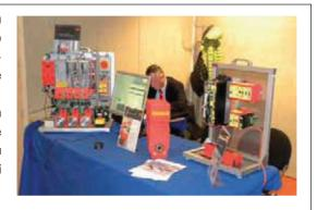
Con il servo drive decentrato Sinamics S120M SIEMENS offre numerosi vantaggi: minore tempo per il cablaggio e minore lunghezza dei cavi, maggiore flessibilità per gli ampliamenti e l'ammodernamento delle macchine, riduzione delle dimensioni e degli ingombri dell'armadio elettrico.
