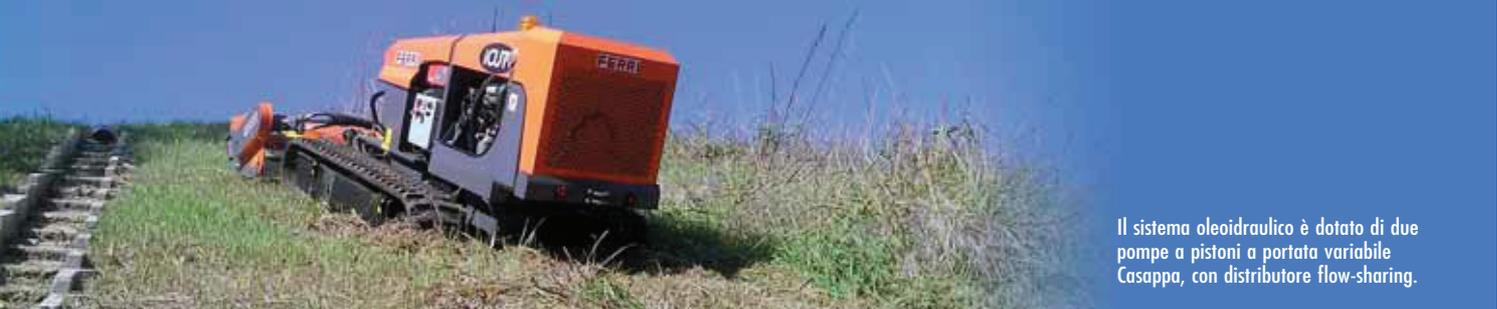
Il sistema oleoidraulico è dotato di due pompe a pistoni a portata variabile Casappa, con distributore flow-sharing.
