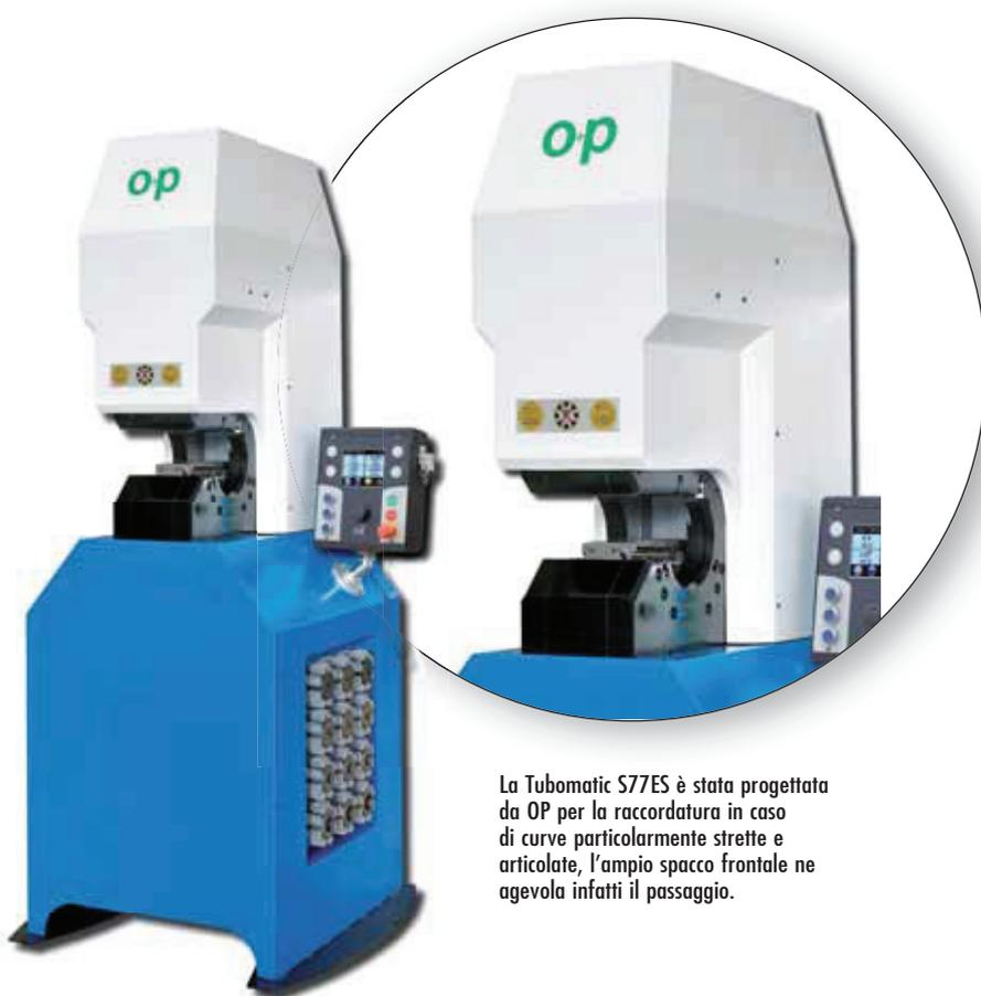
La Tubomatic S77ES è stata progettata da OP per la raccordatura in caso di curve particolarmente strette e articolate, l'ampio spacco frontale ne agevola infatti il passaggio.
