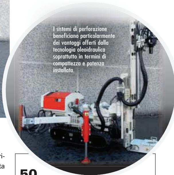
I sistemi di perforazione beneficiano particolarmente dei vantaggi offerti dalla tecnologia oleoidraulica soprattutto in termini di compattezza e potenza installata.
