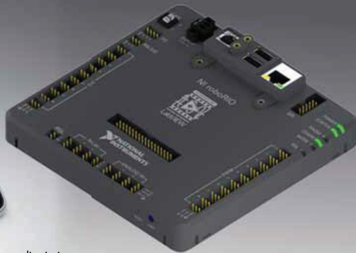
Il controller roboRIO è pensato per le applicazioni di robotica in ambito educativo e scolastico.
