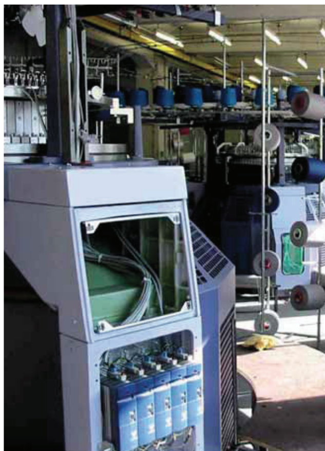
La sede di Bonfiglioli Vectron, il particolare del quadro di una macchina tessile con inverter Bonfiglioli e il particolare del servo package BMD+MP.
