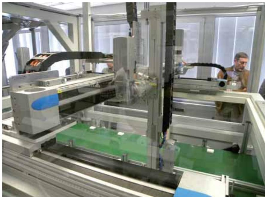
La cella robotizzata con robot antropomorfo Kuka e il sistema ad assi paralleli Festo.
