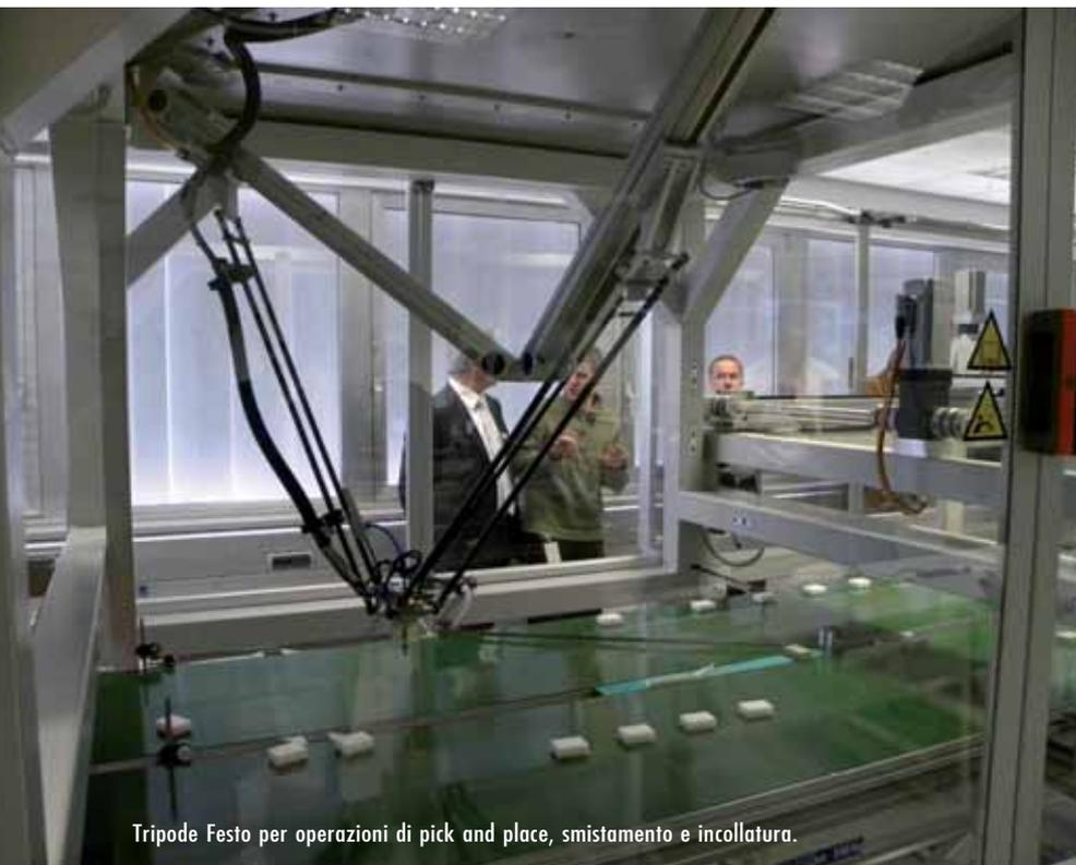
Tripode Festo per operazioni di pick and place, smistamento e incollatura.
