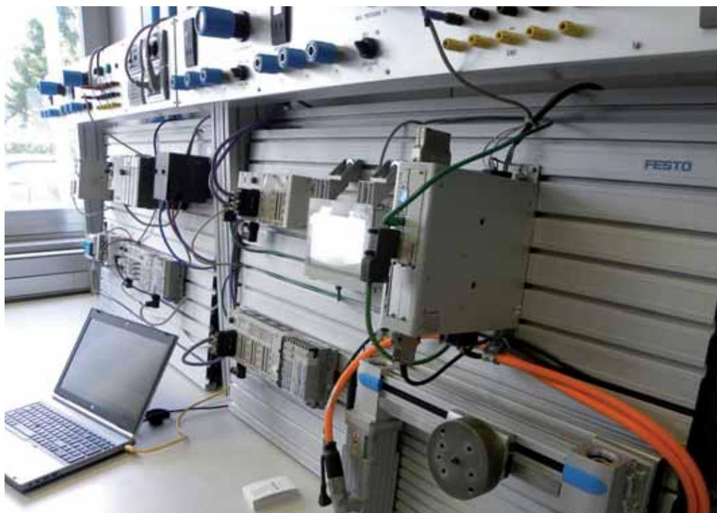
Banco dimostrativo dell'Application center Festo: in primo piano il PLC Cpx, l'azionamento Cmpmp-as e il motore Emms-as.
