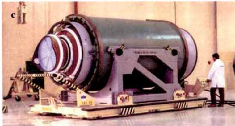
Figura 4 - Movimentazione di carichi pesanti con pattini ad aria commercializzati da Prexco.
