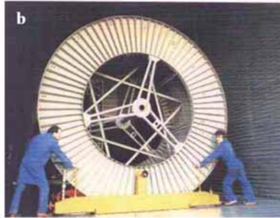
Figura 4 - Movimentazione di carichi pesanti con pattini ad aria commercializzati da Prexco.
