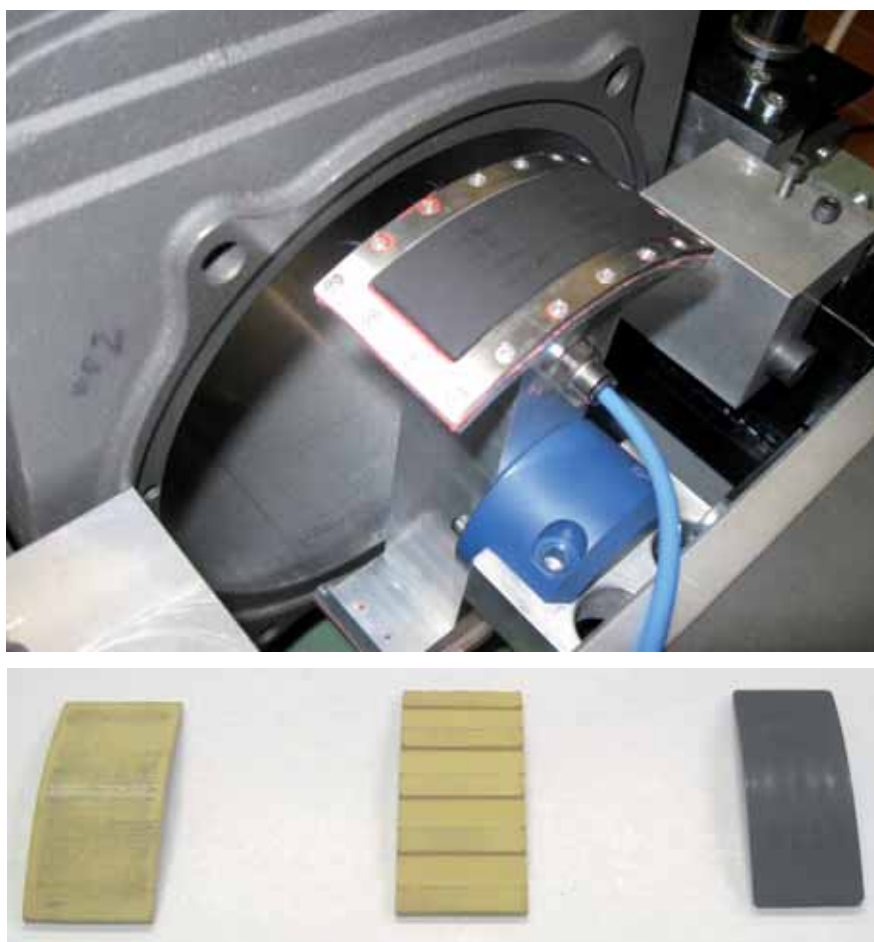
Figura 2. Dettaglio dell'equipaggio mobile con portacampioni. Tipologie di campioni ricavate da fasce guida in prova.
