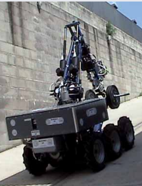
Immagine di un prototipo di telemanipolatore con trazione elettroidrostatica sviluppato presso il Politecnico di Torino.
