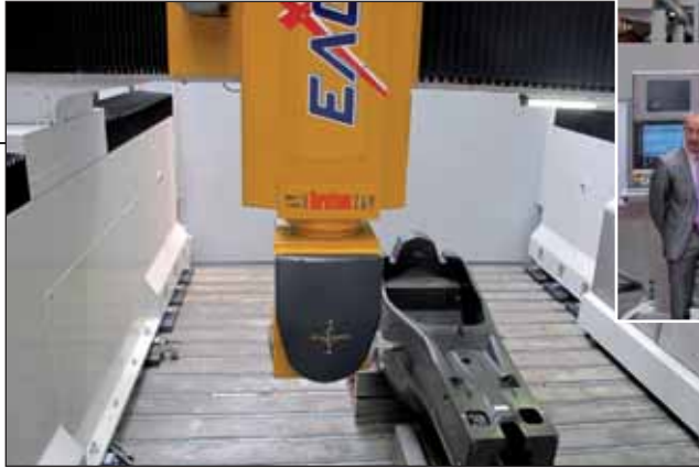
Eagle: centro di lavoro verticale ad alta velocità a 5 assi continui per fresatura di particolari in lega leggera, composito e resina. Flymill: centro di lavoro cnc verticale ad alta velocità a 5 assi continui interpolati per fresatura di acciaio, alluminio, composito e resina. Maxima: centro di lavoro verticale multifunzione ad alta velocità a 6 assi continui per fresatura e tornitura verticale di particolari fino a 3.500 mm di diametro.
