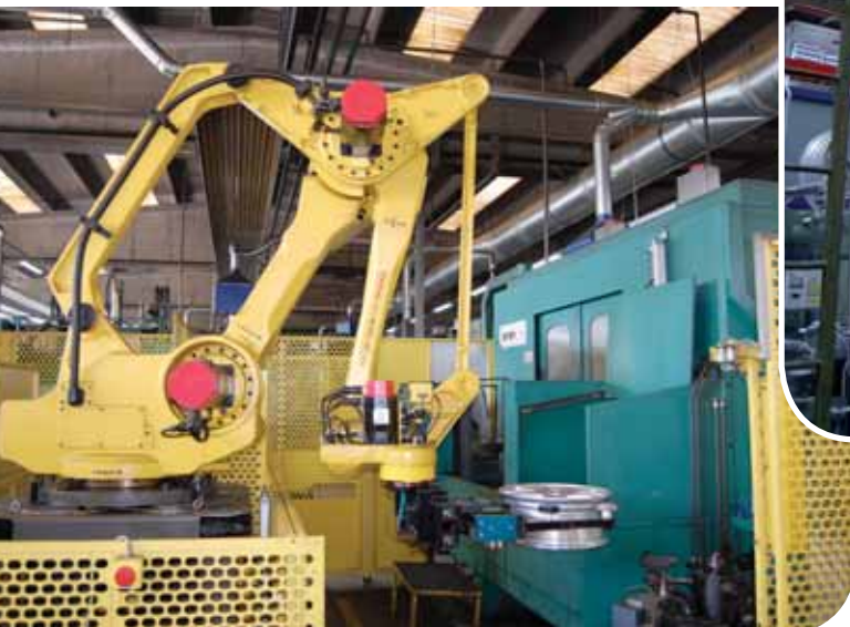
Sopra, tutte le fasi di finitura sono automatiche, effettuate in moderni impianti a basso impatto ambientale. A sinistra, Le lavorazioni meccaniche vengono svolte con l'ausilio dei sistemi robotizzati Fanuc.
