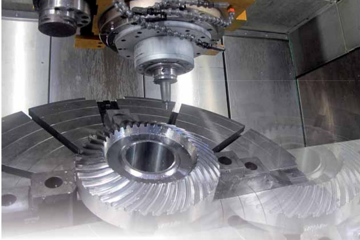
di Hermle sono le nuove architetture di supporto degli assi principali, così come il posizionamento strategico delle guide con la spinta delle slitte nel baricentro della macchina.
