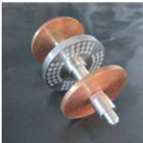
Il prototipo di rotore a levitazione magnetica passiva.
