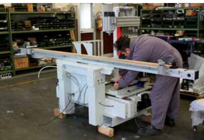
Un tecnico Framar impegnato nel montaggio delle guide lineari Rollon.
