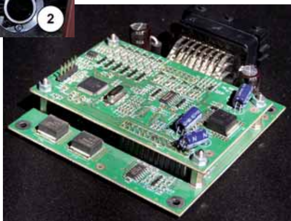
Layout sperimentale per la pompa in prova (sinistra) e scheda elettronica di controllo realizzata da Imamoter.
