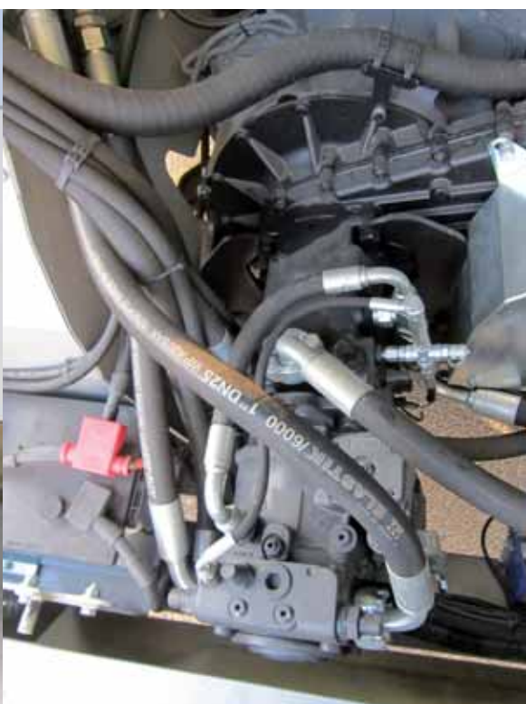
Componenti pompe A4VG tipo EP e EZ per funzioni fresa e trazione idrostatica.
