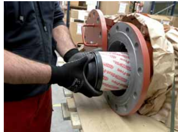
Fase di montaggio del filtro modello Stat Free che elimina le correnti elettrostatiche.
