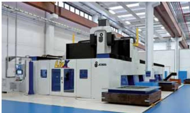
LinX Millturn, centro di fresatura e tornitura integrate a motori lineari ad altissima velocità della Jobs.
