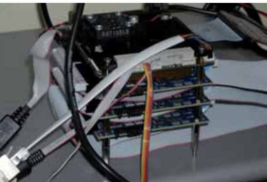
2. La scheda comprendente il microprocessore di acquisizione dati e controllo.
