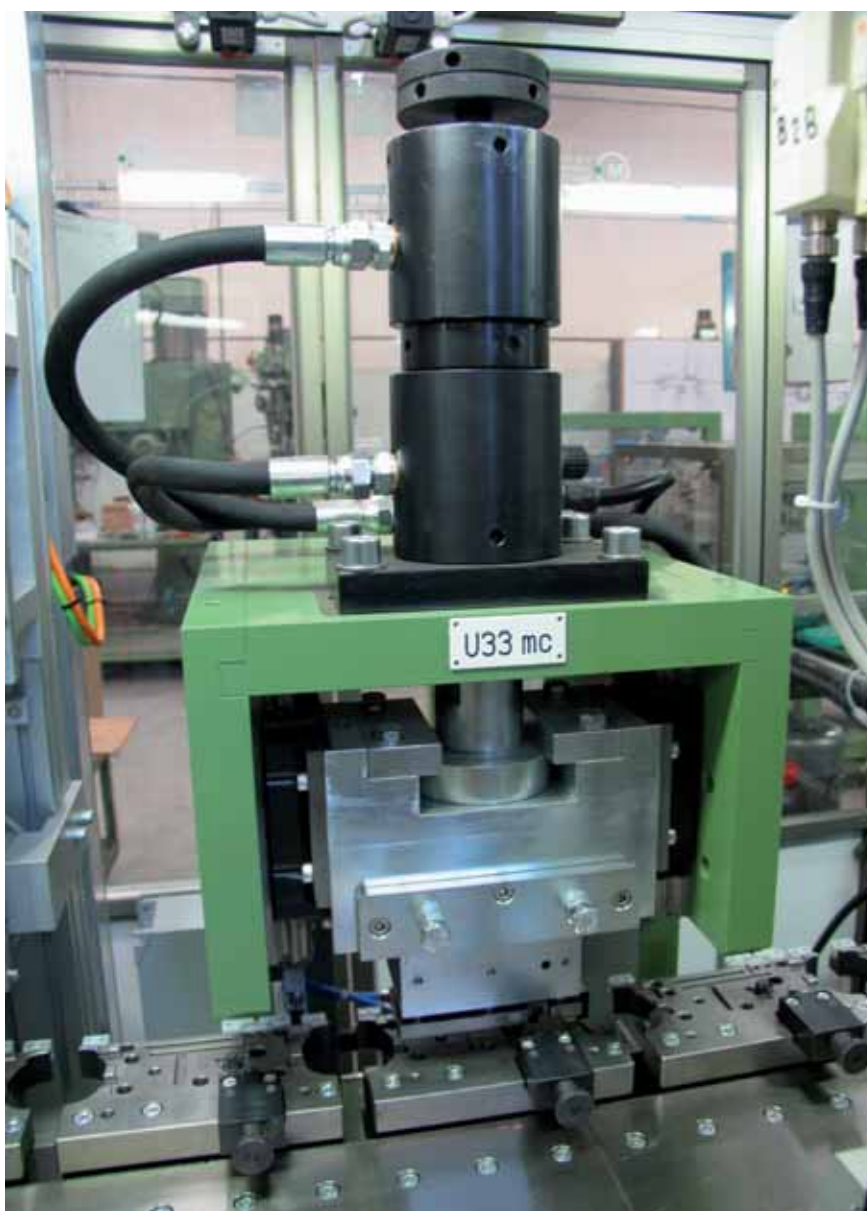
L'unità 33 effettua la cianfrinatura del coperchio mediante un cilindro oleodinamico.
