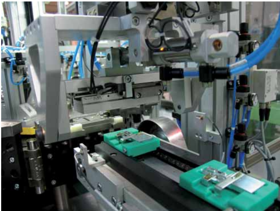
La stazione 21 ha il compito di inserire il chiavistello completo all'interno della serratura in costruzione.
