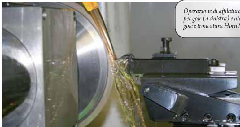
Operazione di affilatura di utensile per gole (a sinistra) e utensile per gole e troncatura Horn S100.
