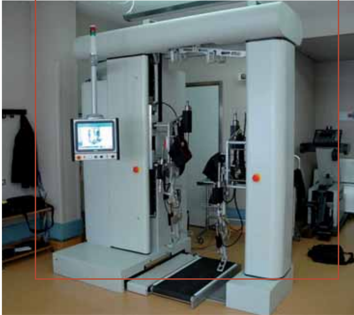
Robot per riabilitazione degli arti inferiori con esoscheletri indipendenti e motori elettrici lineari.
