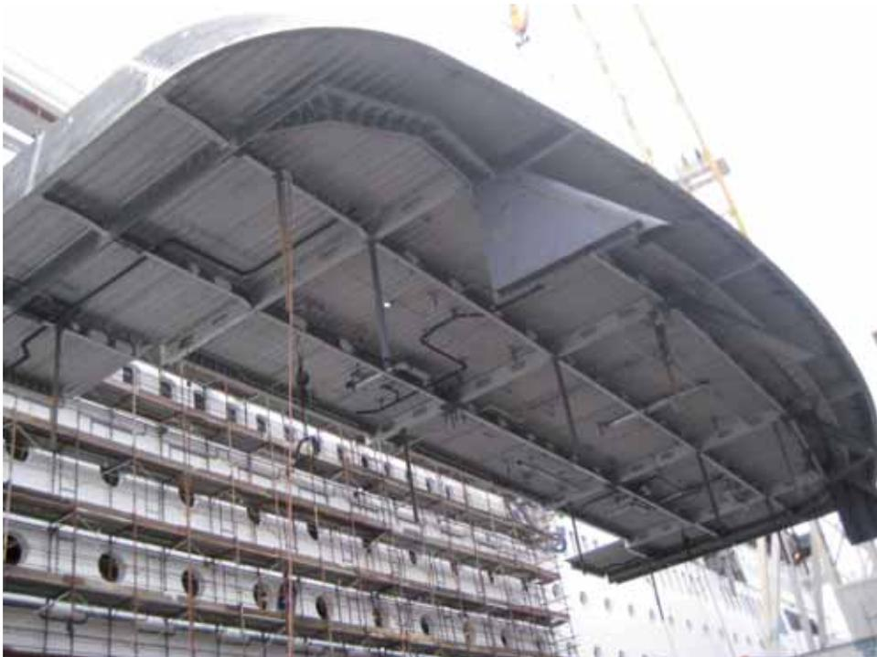
Il peso di una struttura in lega di alluminio è inferiore del 50% rispetto ad un'analogia struttura in acciaio.
