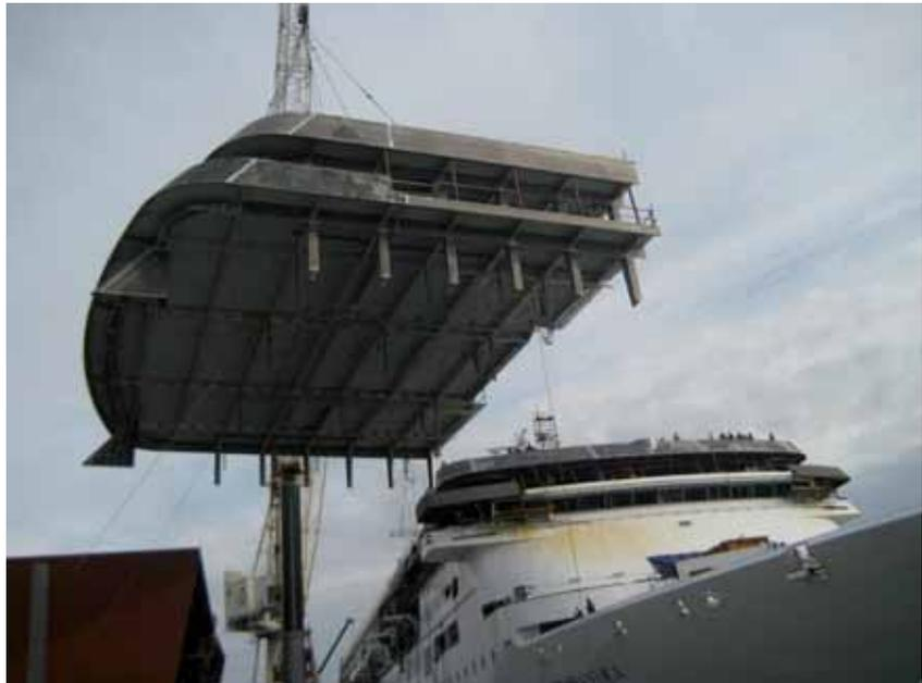
ex novo di 120 cabine e suite con balcone privato. Per Costa Romantica Metra ha fornito i profilati estrusi strutturali in lega alluminio-magnesio-silicio EN AW 6082 T6 per la realizzazione dei due semiponti. Tipologia di lega in cui il magnesio e il silicio sono i principali alliganti che presentano le seguenti caratteristiche: elevata formabilità a caldo, buona deformabilità a freddo, ottima resistenza alla corrosione e stabilità, unite ad elevate caratteristiche meccaniche.
