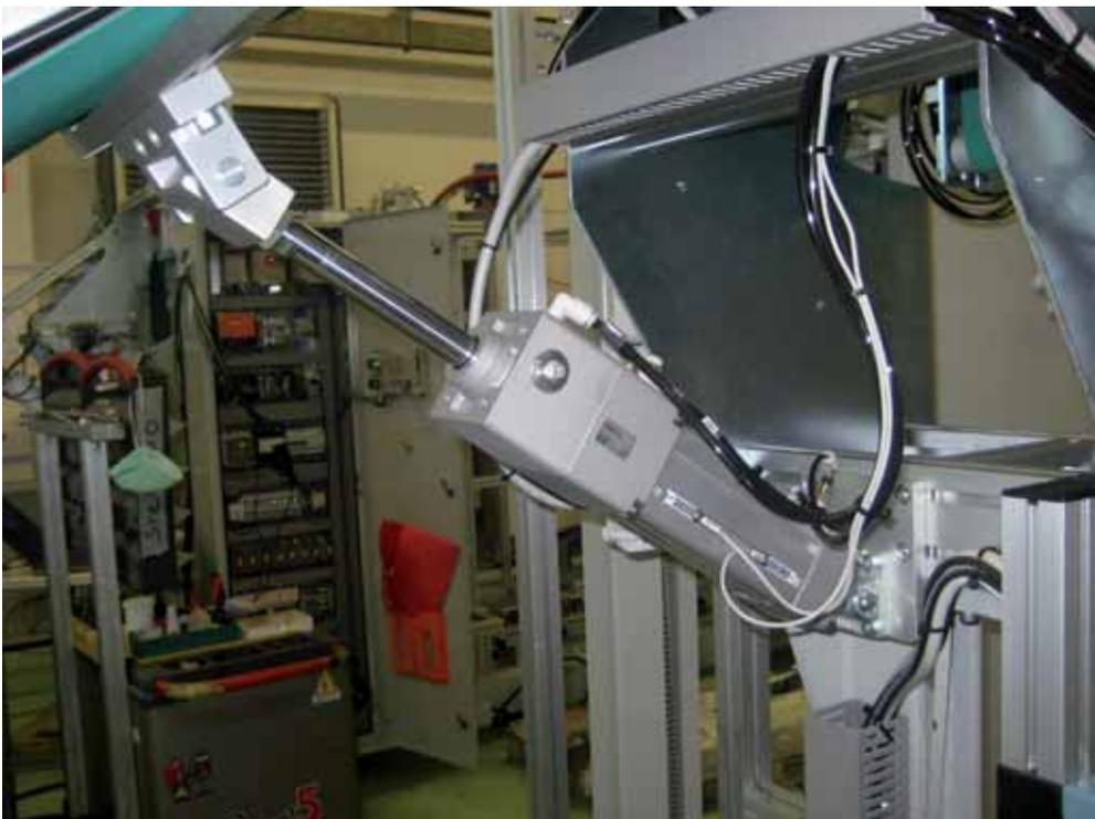
Cilindro per la movimentazione del tappeto per l'impilatura delle calze.
