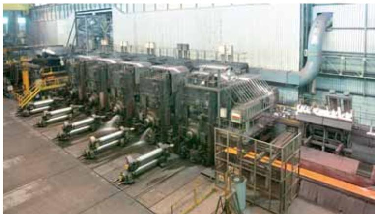
Nel 1992, con la linea ISP (In-Line Strip Production) si realizza la trasformazione dell'acciaio liquido in rotoli di qualità tramite colata e laminazione in continuo nella prima fase di laminazione.
