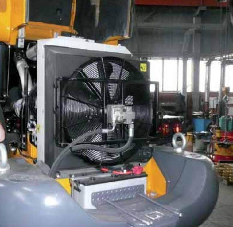
Motore a ingranaggi Casappa per il funzionamento del sistema fan drive.
