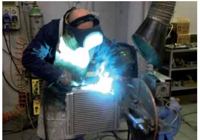
Fase di saldatura degli scambiatori di calore.
