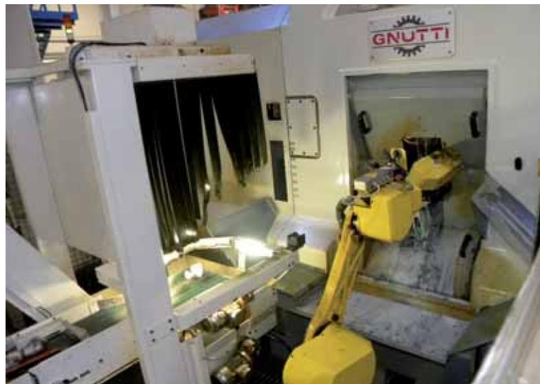
Lanterni in lega d'alluminio. Possono arrivare fino a un diametro massimo di 800 mm. Nel reparto produttivo OMT sono presenti macchine utensili a CNC asservite da robot.
