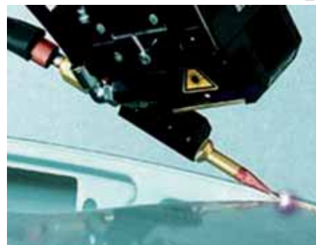
Processo di saldobrasatura laser del portellone posteriore.
