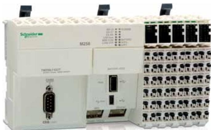
Il Modicon M258 Logic Controller è destinato ai costruttori di macchine (OEM).
