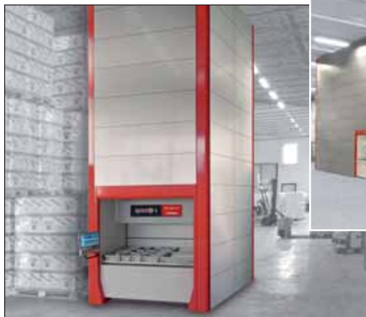
Spazio 1: magazzino verticale automatico.
