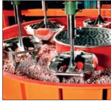
Processo di finitura pezzi in Drag Finishing Machine Pulimandrino.
