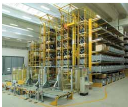
Traslo: sistema di stoccaggio con impianto trasloelevatore.
