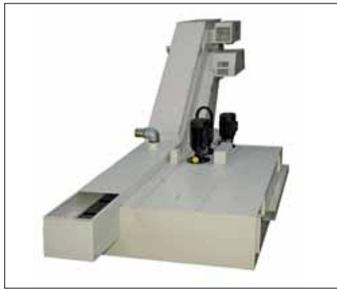
Impianto di evacuazione con trasportatori a tappeto, dragante e rotofiltro integrato.
