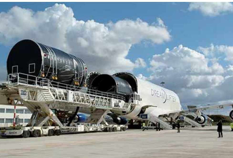
Caricamento delle sezioni 44 e 46 del Boeing 787 prodotte in fibra di carbonio da Alenia Aeronautica.
