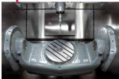
concepito solo per il posizionamento del pezzo di lavorazione, è montato un piano girevole CN completo, che nella versione C 42 U MT Dynamic è predisposto per raggiungere una velocità massima di rotazione di 800
