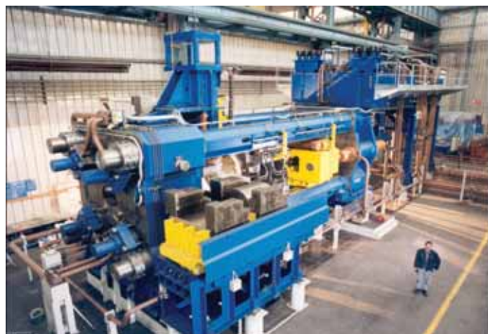
L'ultima pressa installata in Metra con una potenza pari a 6.050 t, per billette da 406 mm.
