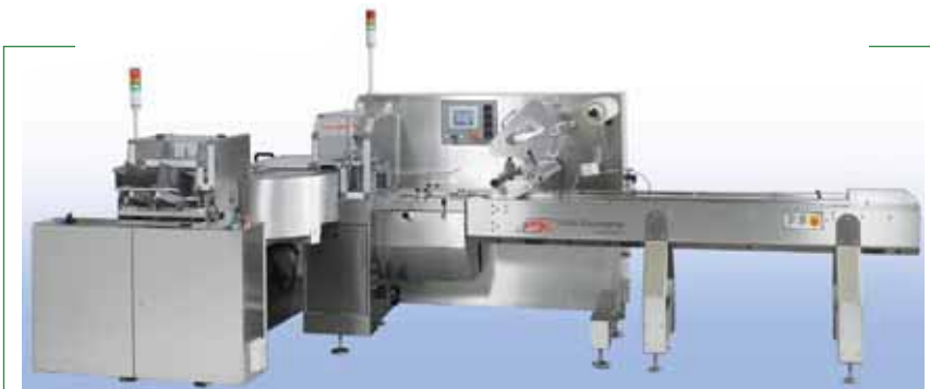
Linea di confezionamento, di Schib Packaging, in atmosfera modificata (Map) con applicatore di cartoncino o cavaliere.
