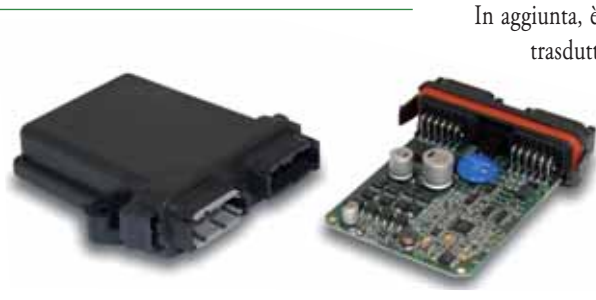
2. Unità elettronica di controllo Walvoil Ced 100X con 4 ingressi analogici, 4 ingressi digitali e 2 uscite.
