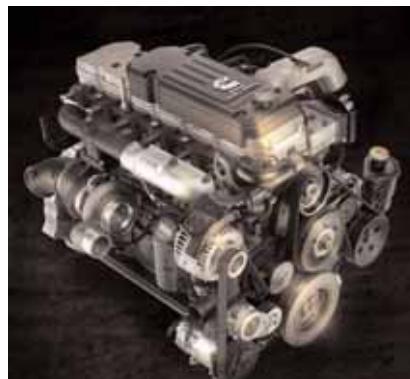
Motore turbodiesel Cummins 6.7 L 350 hp, usato sui veicoli pesanti Dodge Ram.
