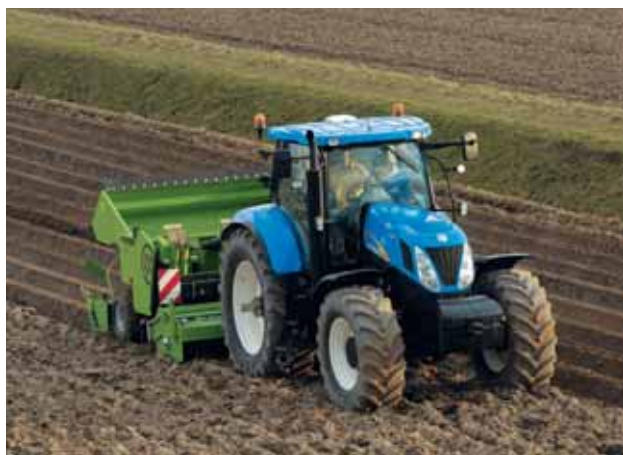
Il T7000 Auto Command è disponibile in 5 modelli, dal T7030 da 167 CV al T7070 da 225 CV. Tutti i motori sono a iniezione elettronica common rail, turbo con intercooler.
