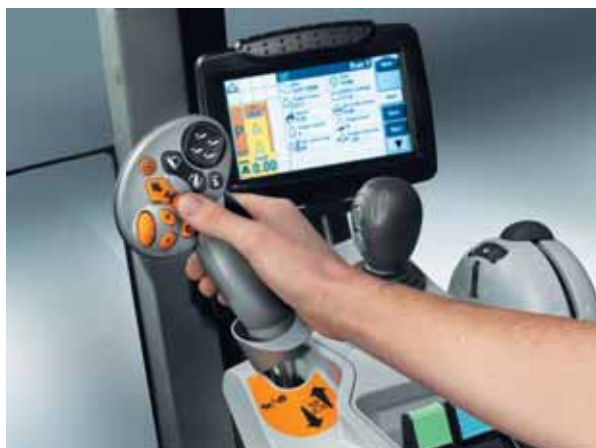
La leva multifunzione Command Grip gestisce la trasmissione proporzionalmente al tempo di pressione.
