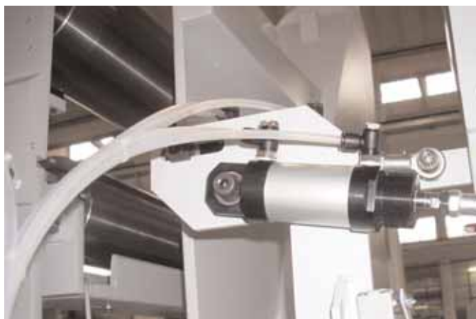
Attuatore pneumatico per il controllo dell'oscillazione del nastro abrasivo.
