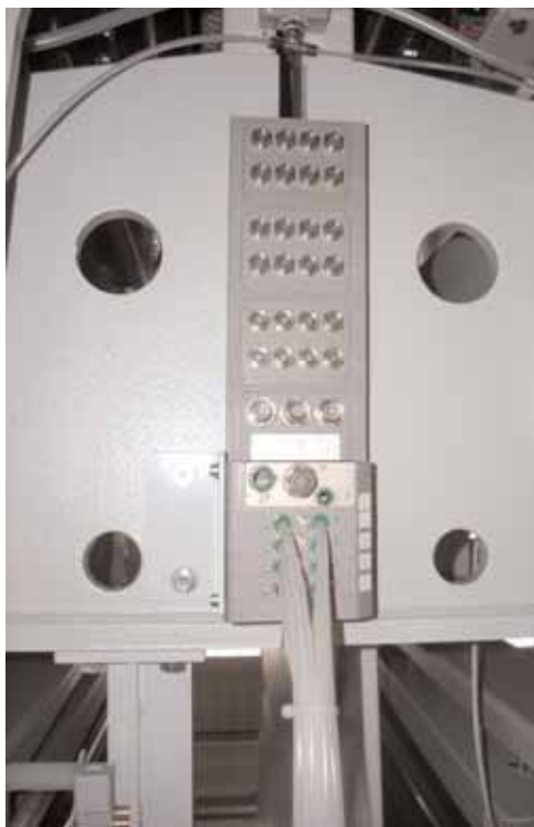
La componentistica pneumatica adottata nelle macchine Tagliabue è Pneumax. In particolare il modulo Canopen gestisce l'automazione di tutta la macchina.
