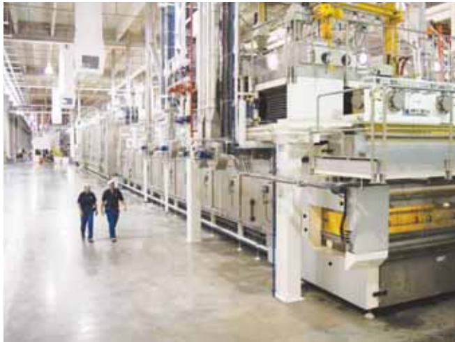
Stabilimento Barilla ad Avon, Usa. Impianto di produzione pasta lunga con capacità giornaliera pari a 200 t.
