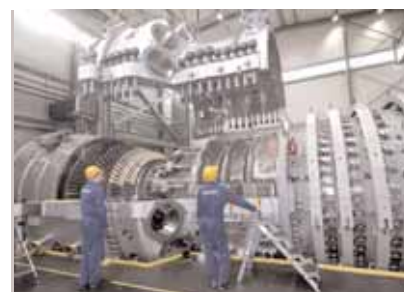
La nuova Turbina a Gas Siemens della Serie SGT5-8000H garantisce, in ciclo combinato, un'efficienza superiore al 60%.
