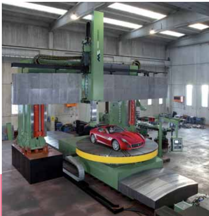
Il tornio TGP.50.6500 a tavola mobile con assi X, Y, Z e tavola mobile a sostentamento idrostatico.
