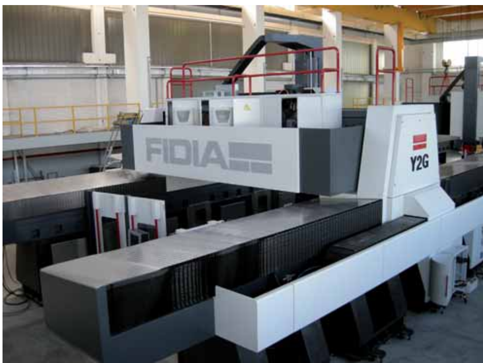
Una delle ultime realizzazioni della Fidia, la fresatrice Y2G, di tipo gantry a doppia traversa e doppia testa a 5 assi continui. Un altro prodotto d'eccellenza della Fidia (sopra) sono le teste di fresatura che, con una gamma completa, abbracciano diverse tipologie di lavorazione.
