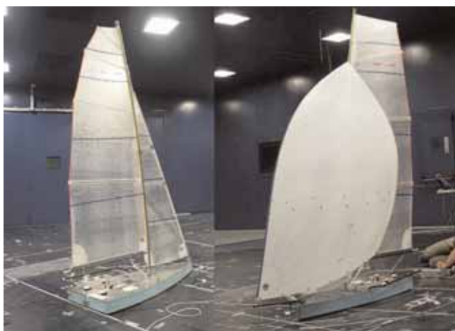
Modello dell'imbarcazione nella galleria del vento.
