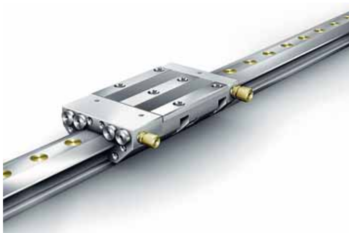
La guida lineare compatta di INA Linear Technology offre eccellenti caratteristiche di smorzamento combinate con elevata rigidità dinamica. Per gli utilizzatori finali questo significa maggiore prestazione di taglio, migliore qualità della superficie e durata dell'utensile più lunga.
