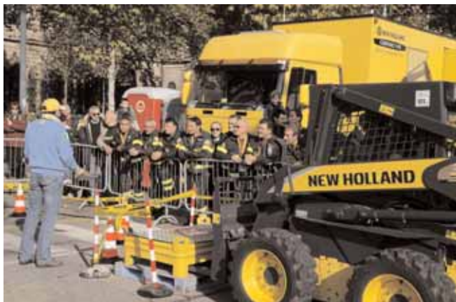
2. La pala gommata compatta utilizza motori per la traslazione del tipo MCR Rexroth accoppiati a una pompa dedicata alla trazione idrostatica.
