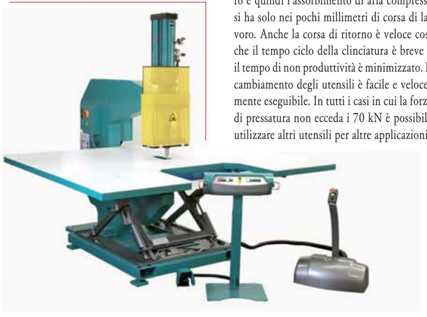
**Vista generale della macchina di clinciatura Tox** per la produzione di pannelli pubblicitari al neon.
